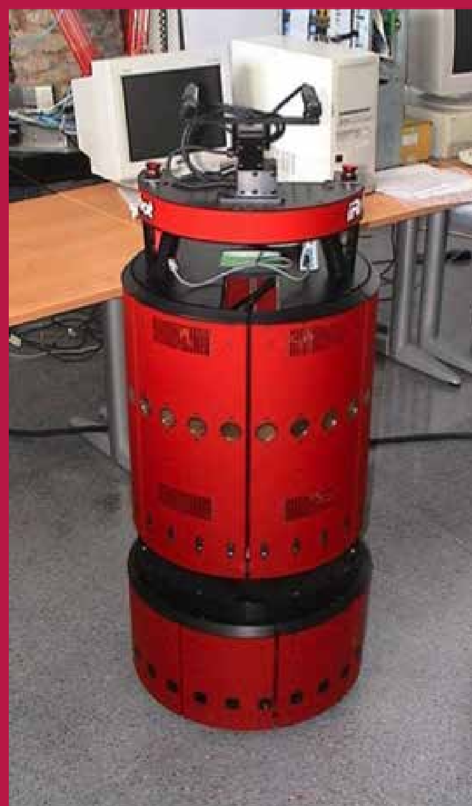
Sistema robótico con módulo de visión artificial utilizado en la Universidad Miguel Hernández para aplicaciones de exploración. / Sistema robòtic amb mòdul de visió artificial utilitzat en la Universitat Miguel Hernández per a aplicacions d'exploració.
