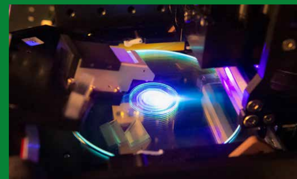
Fotografía de un prototipo de memoria holográfica que puede almacenar 500 GB de datos en el volumen de un disco holográfico. / Fotografia d'un prototip de memòria hologràfica que pot emmagatzemar 500 GB de dades en el volum d'un disc hologràfic.
